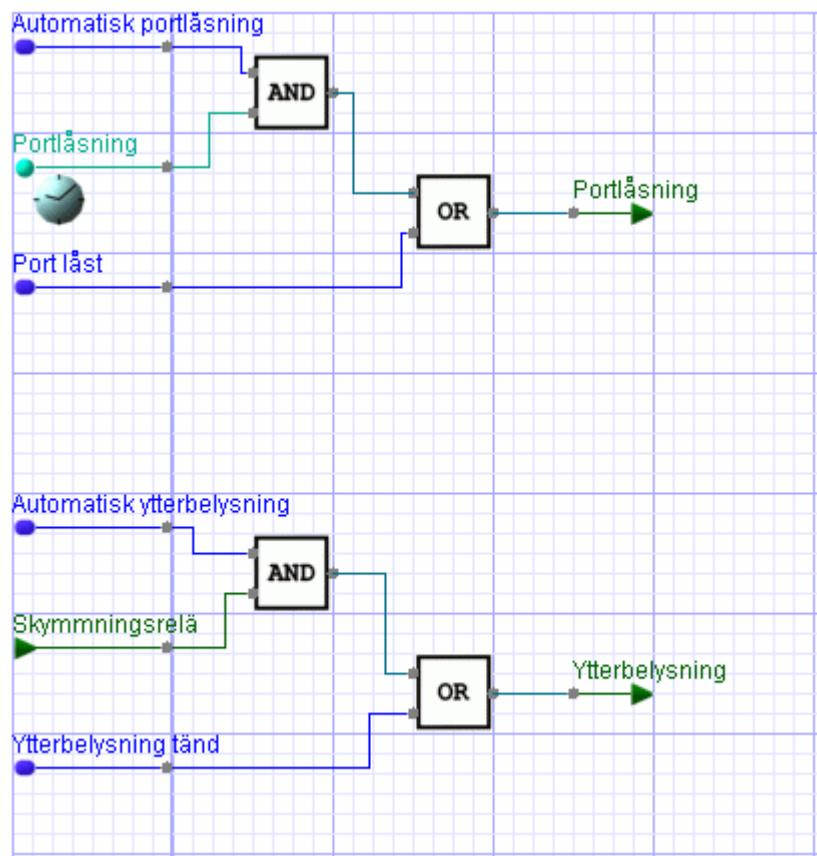
För att portlåsningen skall ske efter kalendern måste parametern ”Automatisk portlåsning” vara till (1). Sätts parametern från (0) är porten öppen. Parametern ”Port låst” har högsta prioritet. Om den är till (1) är porten låst oavsett övriga inställningar.
