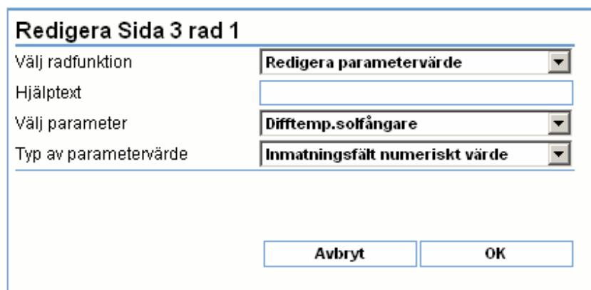
Gör sedan tre rader till med parametrarna Hysteres solfångare, Stopptemp solfångare och Effektfaktor, på samma sätt. För parametern Manuell solpump väljer du typ av parametervärde = Checkbox Till/Från. I övrigt som föregående.
