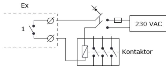
Expansionsmoduler med trepolig plint uppmärkt NC, COM och NO har växlande relä, även kallat SPDT. När utgången är från (0) så är NC och COM anslutna till varandra. När utgången är till (1) så är NO och COM anslutna och den gula lysdioden lyser.
